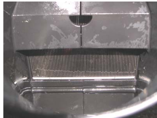
Gereinigte Siebrückseite nach wenigen Sekunden der Reinigung mit einem Hochdruckreiniger von der Oberseite
