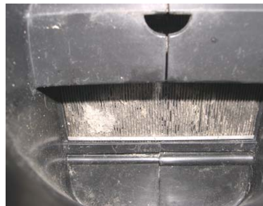
Rückseite eines stark verschmutzten Filtersiebes
